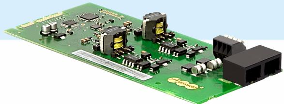
Erweiterung für ITK-Systeme der COMpact-Familie um zwei analoge Amtsköpfe mit integrierter Faxweiche
