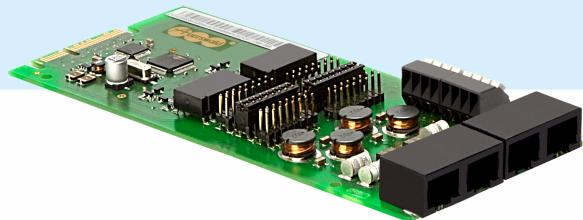
Erweiterung für ITK-Systeme der COMpact-Familie um zwei variable ISDN-Ports (extern/intern)
