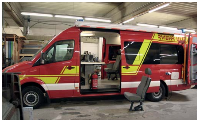
Kommunikationszentrale: Den VW Crafter TDI baute ALUCA für die BF Ulm als ELW 2 mit einem hydraulisch ausfahrbaren Mast aus.
